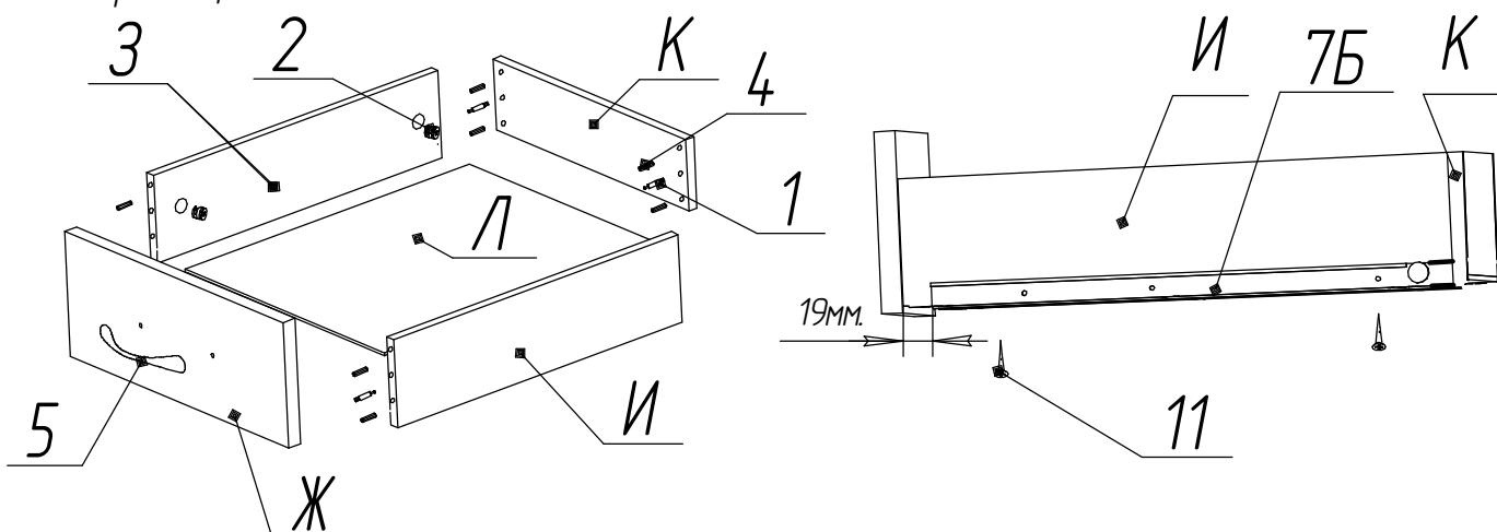
В отверстия диаметром 5x11 мм. на панели ящика Ж, и задней стенке К вкрутить винты эксцентриковые поз 1, в отверстия диаметром 8x14 вставить шканты поз 4. В отверстия диаметром 15 мм. боковых стенок ящика З и И вставить эксцентрики поз. 2.
